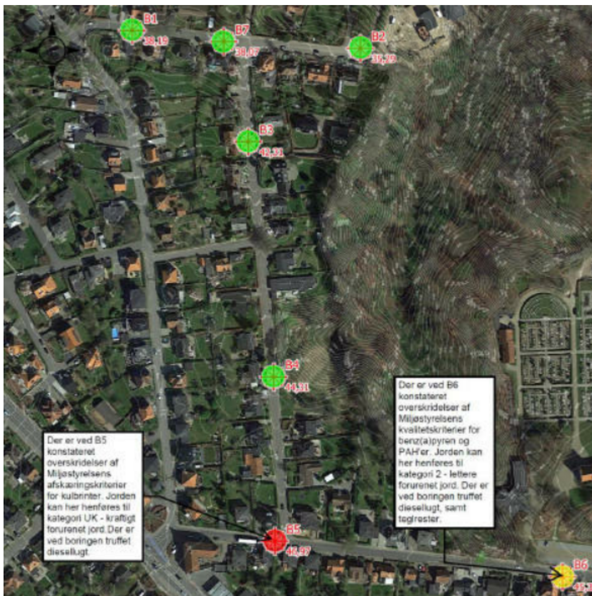
Figur 1: strækninger med forurenet og lettere forurenet vejopbygning
