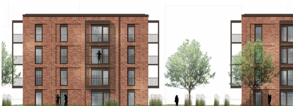
Figur 17: Illustreret facadetegning af punkthusbebyggelse i delområde 2 viser facader i røde tegl med variation i forbandt og reces i murværket omkring vinduespartierne.
