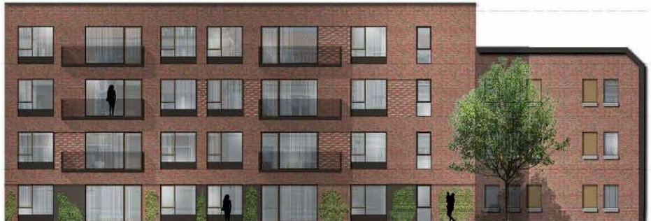
Figur 16: Illustreret facadetegning af ny bebyggelse i delområde 3 viser facader i røde tegl med mønstret murværk mellem flere af vinduerne. Mursten og facadeudformning er tilpasset den eksisterende bygning, der ses th. på illustrationen.
