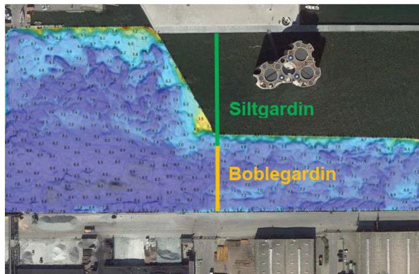
Figur 2: principskitse for placering af siltgardin og boblegardin i havnebassinet. (Kilde: Hercules Fundering).
